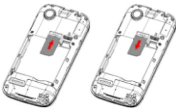
当您需要取出 SIM 卡时，请先关机，移去其他外部电源和电池，再取出 SIM 卡。
